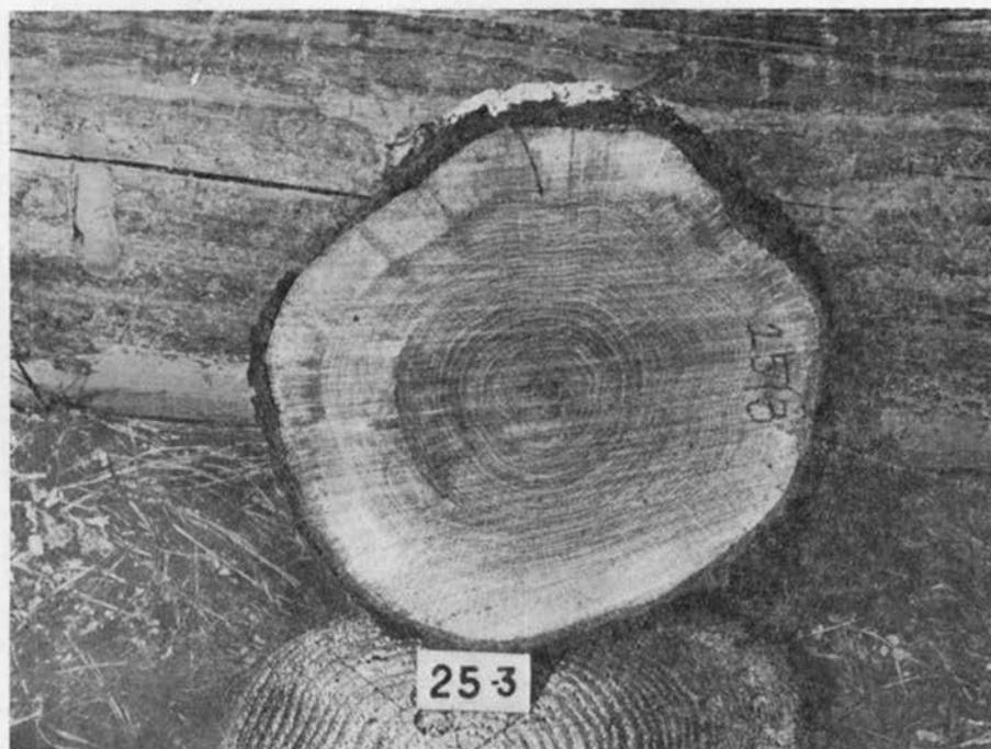
Abb. 2. Eichensplint, auf 4 Punkte bewertet (höchstens 50% der Splintfläche verfärbt)
